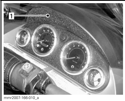
1. Suodatin asennettuna ilmanottokanavaan
