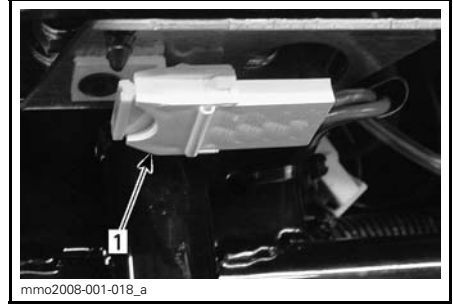
MOOTTORITILA — KONSOLIN ALLA 1. Sulakkeenpidin
