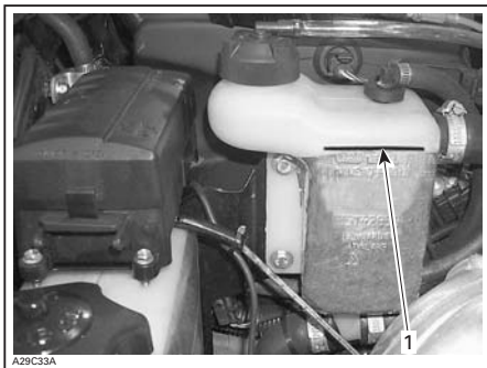
EXPEDITION TUV 600 HO SDI — PAISUNTASÄILIÖ LÄHELLÄ TUOREVOITELUÖLJYSÄILIÖTÄ
