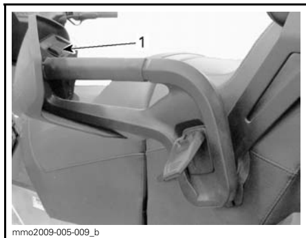
1. Omkopplare för passagerarens handtagsvärmare
