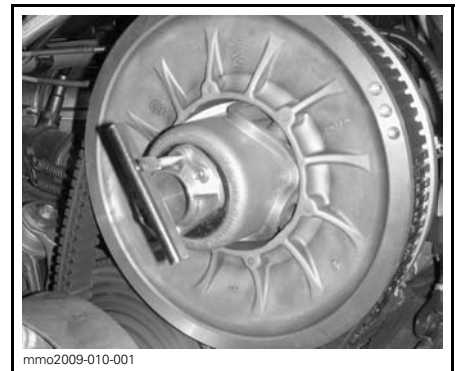
AVAUSTYÖKALU ASENNETTUNA RUUVISÄÄTIMELLÄ VARUSTETTUUN II-VARIAATTORIIN
