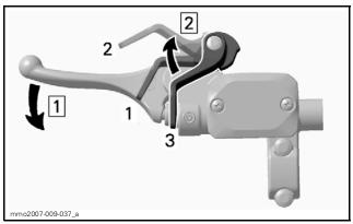
TYPICAL — ENGAGE MECHANISM
