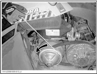
TYPICAL — BOMBARDIER\* LITE DRIVE PULLEY TYPE
