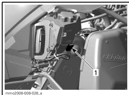
TYPIQUE — DROITE DU COMPARTIMENT MOTEUR 1. Fusible principal 5 A
