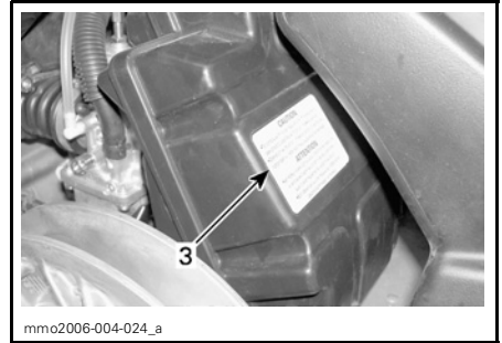
SILENCIEUX D'ADMISSION D'AIR (CÔTÉ MOTEUR) — REFROIDISSEMENT PAR VENTILATEUR
