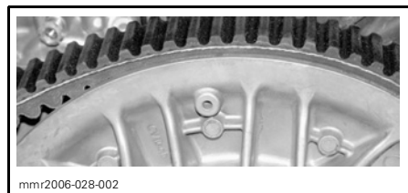
– Desserrer les deux écrous de réglage de la poulie menée.
