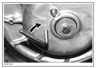
PROPER TOOL OPENING DRIVEN PULLEY OF MX Z X 440
