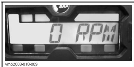
3. MAINTENIR enfoncé le bouton du sélecteur pendant 2 secondes. L'affichage passe alors au mode vitesse, au mode régime du moteur (tr/min) ou au mode combiné.
