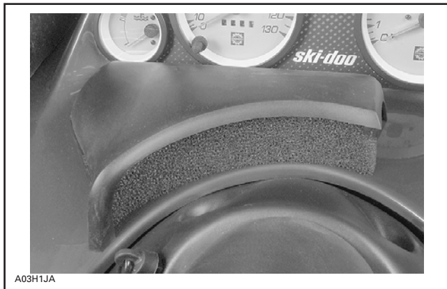
TYPIQUE — FILTRE EN PLACE
