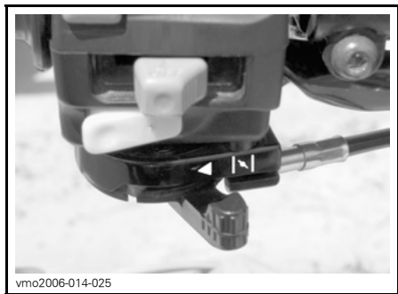
LEVA DEL DISPOSITIVO DELL'ARIA IN POSIZIONE OFF
