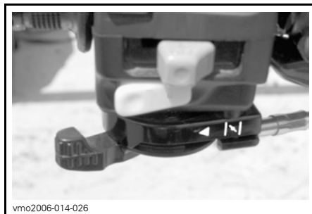
DISPOSITIVO ARIA IN POSIZIONE FULL
