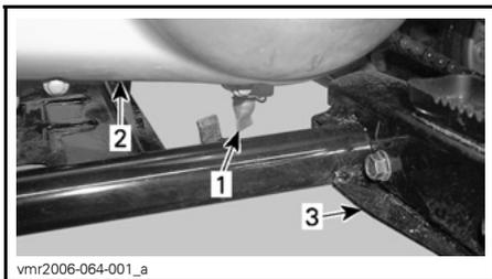
1. *Tubo de vaciado de la cubierta de la CVT*
