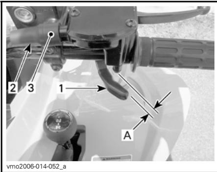
1. Palanca del acelerador
