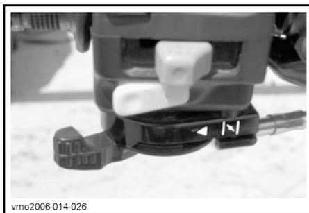
*CHOKE IN VOLLSTÄNDIG GEÖFFNETER POSITION*
