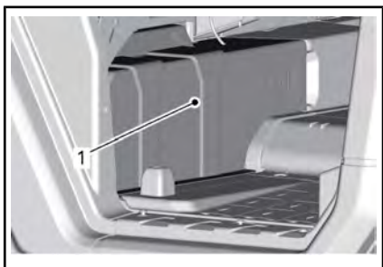
1. Крышка аккумуляторной батареи
