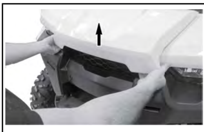
DE RAND VAN HET VOORSTE ONDERHOUDSDEKSEL OPTILLEN.
