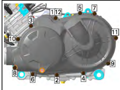
HD5 - AANDRAAIVOLGORDE CVT-DEKSEL
