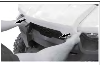
TREKKEN AAN DE RAND VAN HET VOORSTE ONDERHOUDSDEKSEL.
