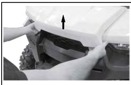
L YFT KANTEN PÅ SERVICEKÅPAN.
