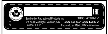
TÍPICA - ETIQUETA DE VIN - DETRÁS DEL ASIENTO DEL COPILOTO
