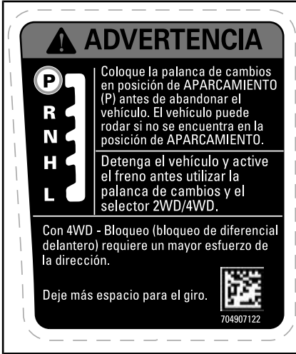
MODELOS DE ETIQUETA 13 CON DIFERENCIAL SMART-LOK
