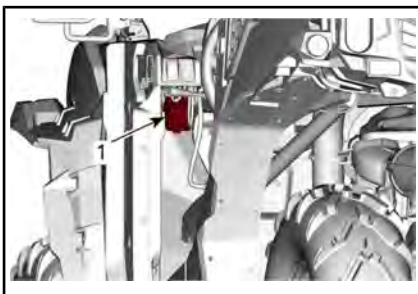
1. Boîte à fusibles avant
