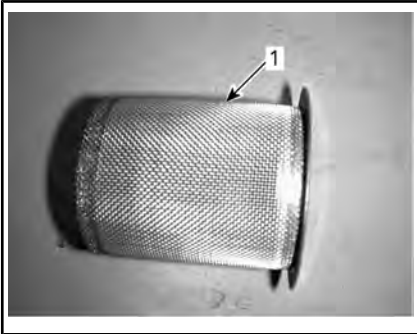
1. Limpieza del supresor de chispas
