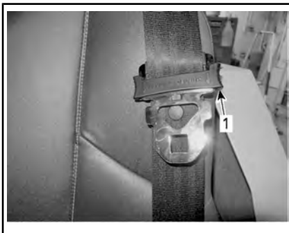
1. Pestaña de bloqueo de deslizamiento
