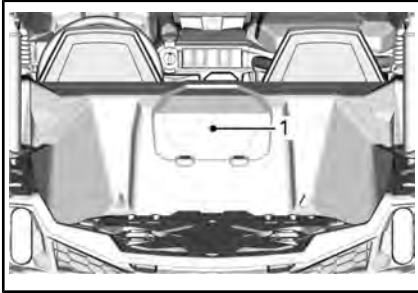
1. Tapa de acceso del depósito de refrigerante
