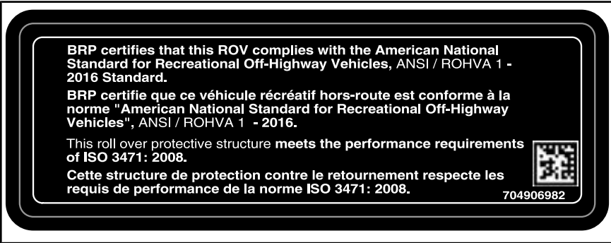
POSITIONNÉE SUR LA BARRE SUPÉRIEURE GAUCHE DE LA CAGE DE SÉCURITÉ FAISANT FACE À L'HABITACLE.
