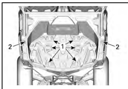
1. LinQ-montagepunten in laadbak 2. LinQ-montagepunt op zijkanten laadbak
