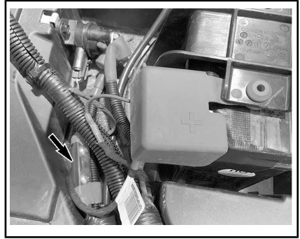
TYPIQUE - PORTE FUSIBLE DE RÉGULATEUR
