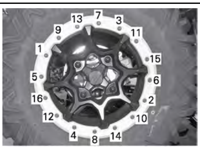
ТИПОВОЙ ВАРИАНТ - ПОРЯДОК ЗАТЯЖКИ ВИНТОВ
