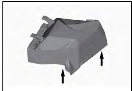
ПОДЪЕМ ЗАДНЕЙ ЧАСТИ КРЫШКИ СЕРВИСНОГО ОТСЕКА
