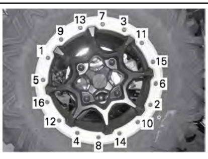
ТИПОВОЙ ВАРИАНТ - ПОРЯДОК ЗАТЯЖКИ ВИНТОВ
