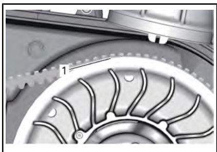
1. Onderste deel van de tanden gelijk met de rand van de aangedreven poelie
