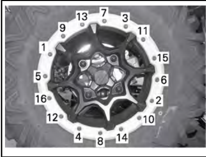
TYYPILLINEN KIRISTYSJÄRJESTYS
