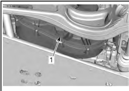
1. Drainage de la boîte de vitesses CVT
