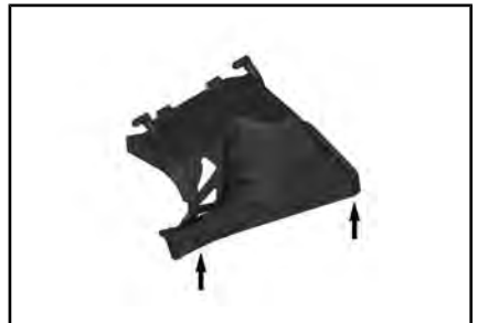
SOULEVEZ L'ARRIÈRE DU COUVERCLE D'ENTRETIEN
