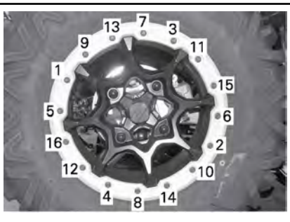
ТИПОВОЙ ВАРИАНТ - ПОРЯДОК ЗАТЯЖКИ ВИНТОВ
