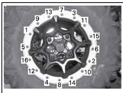
SITUAZIONE TIPICA - SEQUENZA DI SERRAGGIO
