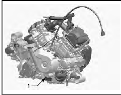
HINWEISSCHILD MIT MOTORSERIENNUMMER
