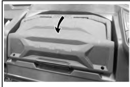
HERAUSNEHMBARE WERKZEUGBOX ENTRIEGELN
