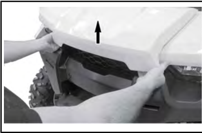
DE RAND VAN HET VOORSTE ONDERHOUDSDEKSEL OPTILLEN.
