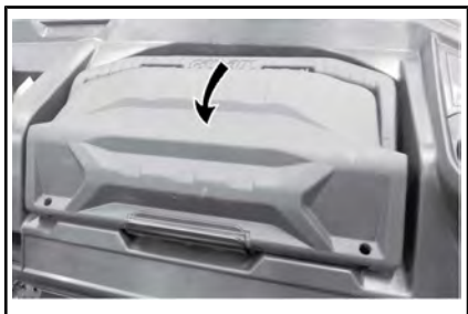
SBLOCCO DELLA CASSETTA DEGLI ATTREZZI ESTRAIBILE
