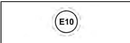
LOCALIZAÇÃO: PERTO DA TAMPA DO TANQUE DE COMBUSTIVEL
