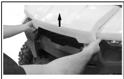
DE RAND VAN HET VOORSTE ONDERHOUDSDEKSEL OPTILLEN.
