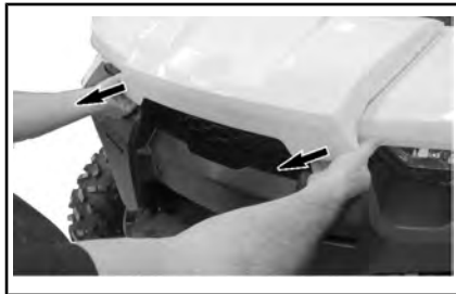
TIRE DEL BORDE DE LA TAPA DE ACCESO DELANTERA.
