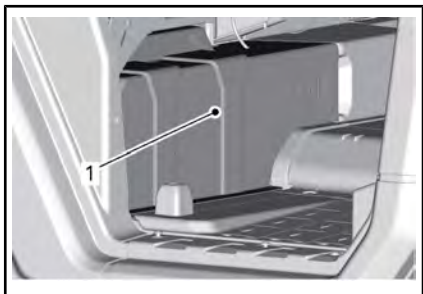
1. Крышка аккумуляторной батареи
