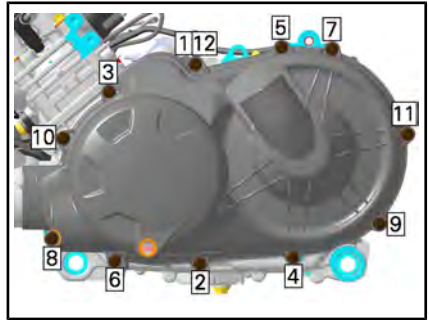
HD5 — ПОСЛЕДОВАТЕЛЬНОСТЬ ЗАТЯЖКИ ВИНТОВ КРЫШКИ ВАРИАТОРА
