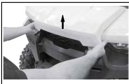
HOCHHEBEN DER WARTUNGSABDECKUNG.
