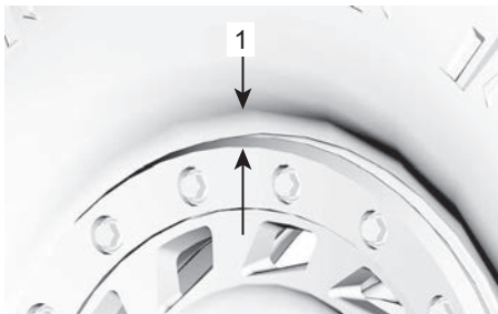
1. Spalt entlang des Beadlock-Klemmrings gleich
