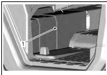
1. Крышка аккумуляторной батареи
