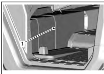
1. Крышка аккумуляторной батареи
