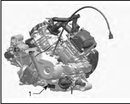
ТИПОВОЙ ВАРИАНТ ДЛЯ МОДЕЛЕЙ HD8 И HD10 — НАКЛЕЙКА С СЕРИЙНЫМ НОМЕРОМ ДВИГАТЕЛЯ
