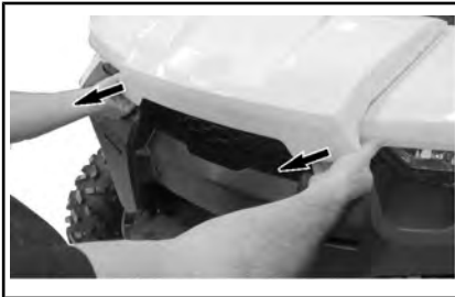
TIRARE DAL BORDO COPERCHIO DI MANUTENZIONE ANTERIORE.
