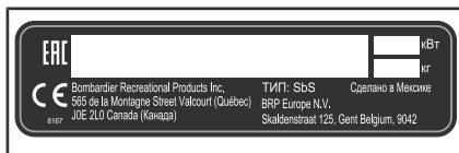
ТИПОВОЙ ВАРИАНТ — НАКЛЕЙКА С VIN-КОДОМ
