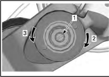
**AMORTIGUACIÓN DE COMPRESIÓN A VELOCIDAD BAJA (UTILICE UN DESTORNILLADOR)**
