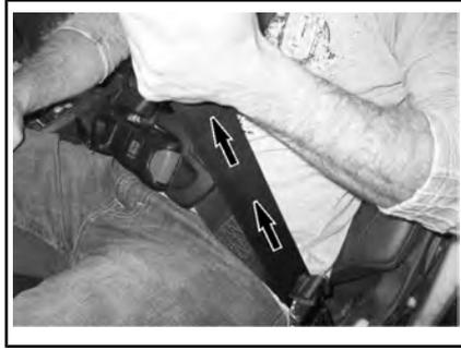
Para aflojar el cinturón, sujete el cinturón del regazo con una mano y tire de la correa roja hacia afuera.
