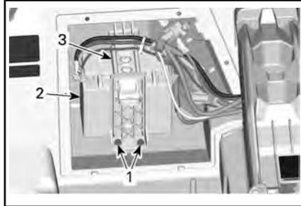
1. Tornillos de sujeción del portabaterías
