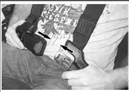
**En ambos lados,** ajuste el cinturón firmemente contra su cuerpo tirando del exceso de cinturón del regazo hacia el interior. La hebilla debe estar centrada en la cintura (lo más baja posible).
