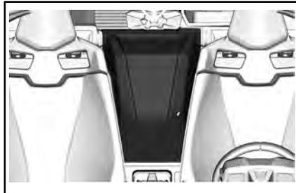
Retire los tornillos de fijación delanteros de la placa protectora.
