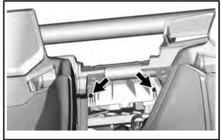
Desconecte la manguera del intercooler.
