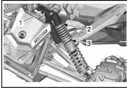
TÍPICO: MODELOS MAVERICK TURBO Y X rc TURBO. SUSPENSIÓN DELANTERA
