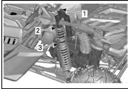
TÍPICO: MODELOS MAVERICK TURBO Y X rc TURBO. SUSPENSIÓN TRASERA
