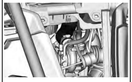
Abra el intercooler y el soporte del tubo del cárter del cigüeñal desmontando el tornillo.
