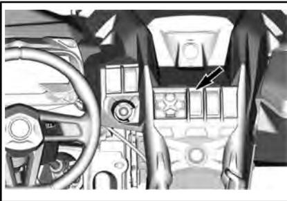
Este interruptor permite seleccionar el modo de tracción a 2 o a 4 ruedas cuando el vehículo está detenido y el motor en marcha.
