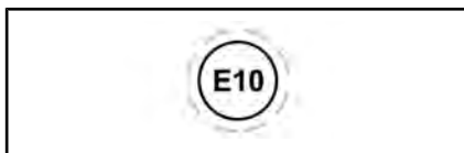
SITUATA VICINO AL TAPPO DEL SERBATOIO
