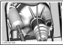
TYPICAL VISCO-LOC- FRONT RIGHT SIDE OF VEHICLE
