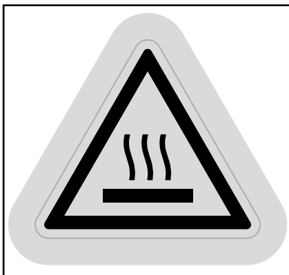
SURFACE CHAUDE - PRÈS DE LA SUSPENSION ARRIÈRE
