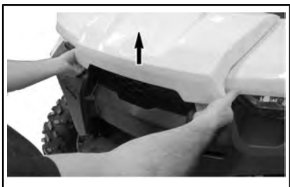
SOLLEVAMENTO DEL BORDO DEL COPERCHIO DI MANUTENZIONE ANTERIORE
