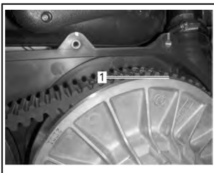
1. Unterster Teil der Zahnräder bündig mit der Außenfläche des Antriebsriemens
