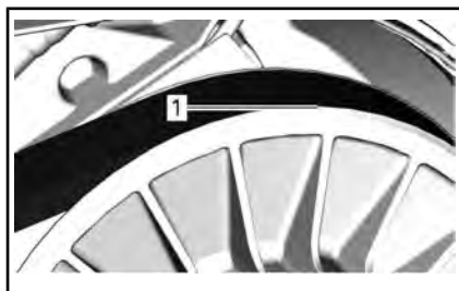
1. Superficie esterna della cinghia di trasmissione
