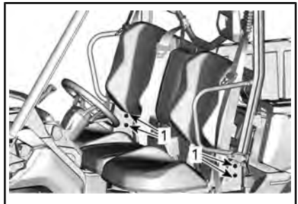
1. Sujeciones inferiores de la jaula
