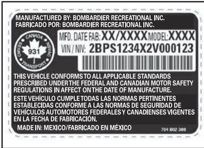
TÍPICO — ETIQUETA DEL NÚMERO DE SERIE DEL VEHÍCULO DETRÁS DEL ASIENTO DEL PASAJERO
