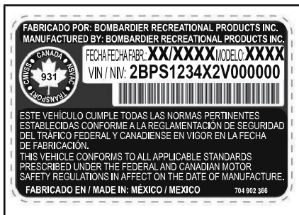
TÍPICO: ETIQUETA CON EL NÚMERO DE SERIE DEL VEHÍCULO BAJO LA GUANTE- RA
