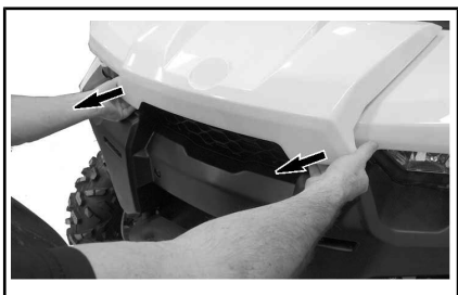
PUXANDO A BORDA DA TAMPA DE MANUTENÇÃO FRONTAL.
